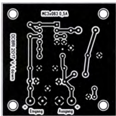
Bild 4: Layout der Unterseite der Platine für die Abwärtsschaltregler; Abmessungen 51 \text{ mm} \times 50 \text{ mm} , M 1:1; die Oberseite bildet eine durchgehende Massefläche.
