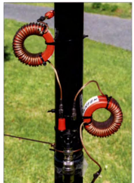
Bild 2: Die steckbaren Fußpunktspulen sind nur für den Betrieb auf 80 m erforderlich.
