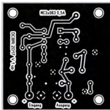
Bild 5: Layout der Unterseite der Platine für die Aufwärtsschaltregler; Abmessungen 51 \text{ mm} \times 50 \text{ mm} , M 1:1; auch hier bildet die Oberseite eine durchgehende Massefläche.
