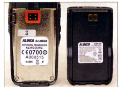
Mit 2,6 Ah bietet der Akkumulator ausreichend Kapazität.
