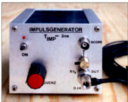
Bild 1: Mustergerät des selbst gebauten Impulsgenerators
