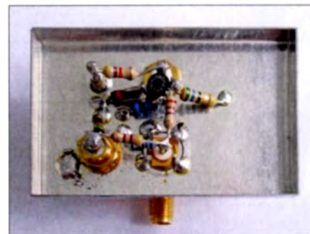
Bild 4: Rückseite des Testaufbaus mit den frei verdrahteten Bauelementen
