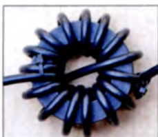
Bild 3: Sperrkreis für 20 m im Kelemen-Sperrkreis-Dipol DP-4020 [5]
