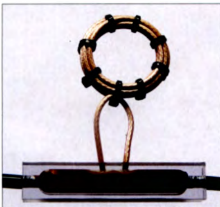
Bild 3: Sperrkreis für 20 m im Kelemen-Sperrkreis-Dipol DP-4020 [5]
