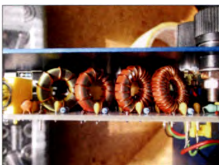
Bild 7: Die Bauelemente der geschalteten Filterzüge des Preselektors sind auch nach der Montage beim Blick hinter die Frontplatte gut zu erkennen.
