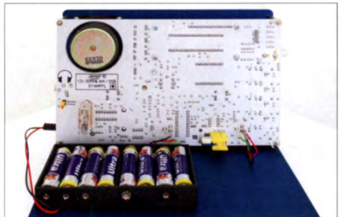
Bild 4: Lötseite der Platine; im Vordergrund die Halterung mit den acht AA-Batterien
