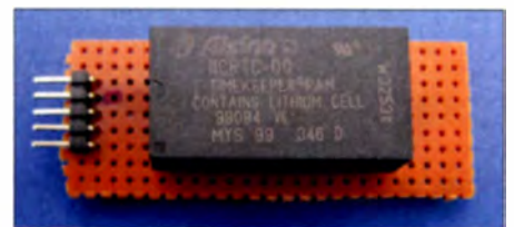
Bild 13: Quarz und Batterie sind im RTC-IC M41T00CAP schon enthalten.
