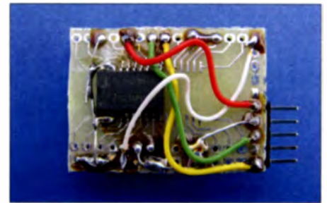
Bild 11: Für das Modul mit dem ISL12022MA kam eine Universalplatine zum Einsatz.
