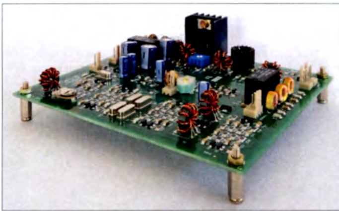
Leiterplatte des vorwiegend mit SMD-Bauteilen bestückten SSB-Transceiver-Bausatzes BITX40; lediglich die externen Komponenten sind in einem Gehäuse unterzubringen.
