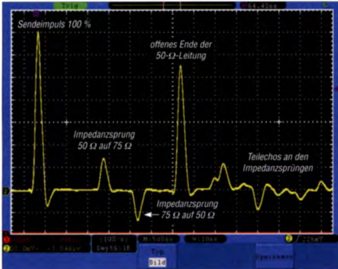
Bild 12: Impulsreflexionen der Leitungsanordnung aus Bild 11; erkennbar sind neben der starken Hauptreflexion nach 7 m Weglänge die beiden Teilreflexionen an den Impedanzsprüngen sowie die Echos und Mehrfachechos dazwischen (rechte Bildseite).
