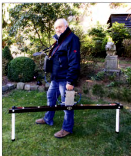
Bild 16: Wolfgang Schüler, DF2DA, mit seinem Ortungsgerät; die beiden Sensorspulen und das Empfangsmodul lassen sich schnell und unkompliziert an der zusammenklappbaren Trageschiene montieren.
