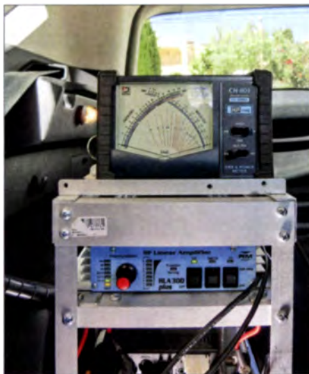
Bild 1: HLA-300-Plus im selbst gebauten Gestell der Mobilstation, hier hinter der heruntergeklappten Rücksitzbank
