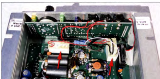
Bild 2: Einbauposition der beiden zusätzlichen Relais; beide liegen mit ihren Arbeitskontakten in Reihe zum jeweiligen Schalter.
