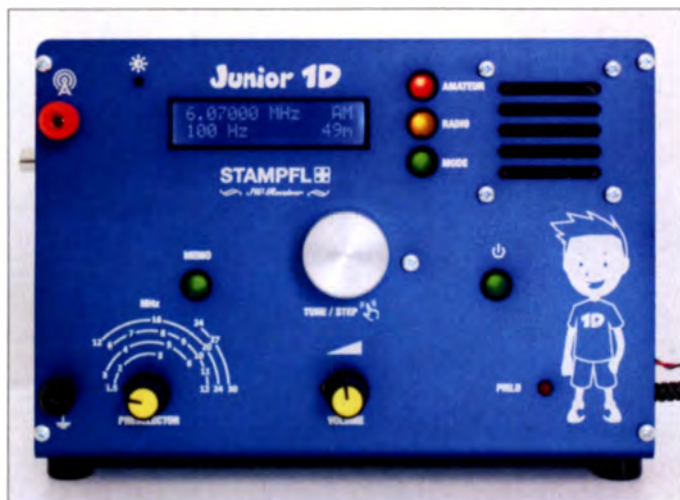
Bild 1: Der Junior 1D ist ein Doppelsuperhet für den Frequenzbereich von 1,5 MHz bis 30 MHz, die Frontseite des Gehäusewinkels ist ansprechend gestaltet und der Empfänger lässt sich weitgehend intuitiv bedienen. Hier im Bild ist z. B. Radio DARC im 49-m-Band eingestellt.
