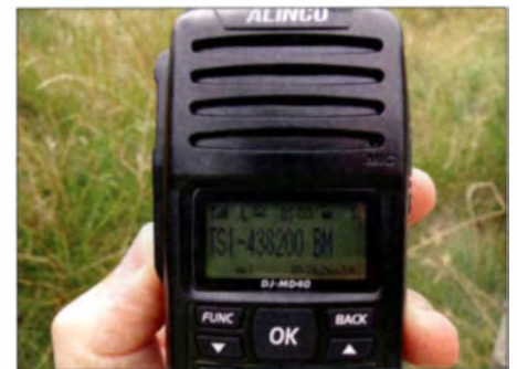
Das monochrome Display lässt sich auch unbeleuchtet hervorragend ablesen.
