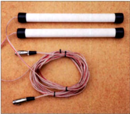
Bild 1: Für die baugleichen eng tolerierten Ferritantennen finden 300 mm lange Stabkerne mit 15 mm Durchmesser in Kunststoffrohren mit Abdeckungen Verwendung.
