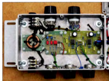
Bild 13: Bei diesem Modul erfolgt die An-kopplung der Sensorenspulen über zwei Über-tragerwicklungen. Anfang und Ende einer Sensor-spule lassen sich umschalten. Das Empfangsfrequenzband ist in vier durch-stimmbare Bereiche unterteilt.
