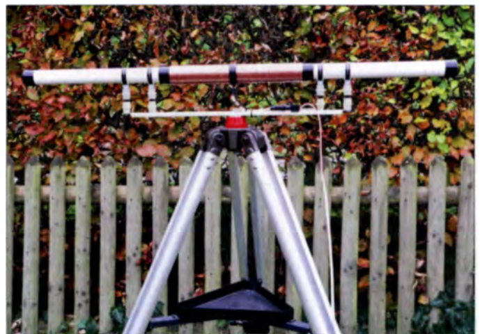
Bild 10: Diese leistungsstarke 1 m lange, auf einem Stativ montierte Ferritantenne eignet sich für den Anschluss an das Modul in Bild 2.
